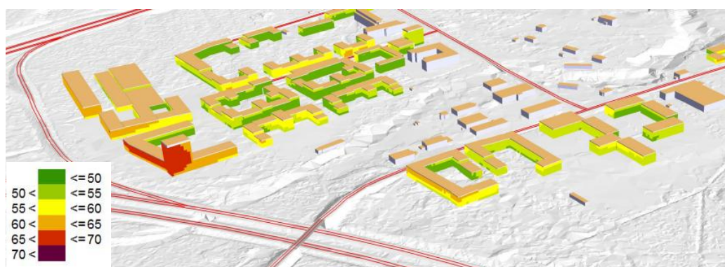
Figur 45. Beräknad ekvivalent ljudnivå (dBA) på fasad om bebyggelse lokaliseras närmast avfarten från E4, avser frifältsvärden. Vy från sydväst. (WSP 2016c)
