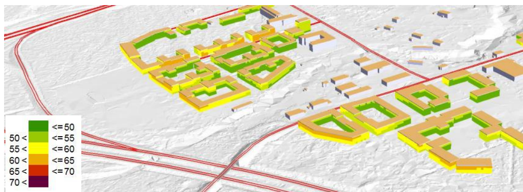
Figur 47. Beräknad ekvivalent ljudnivå (dBA) på fasad om ingen bebyggelse lokaliseras närmast avfarten från E4, avser frifältsvärden. Vy från sydväst. (WSP 2016c)
