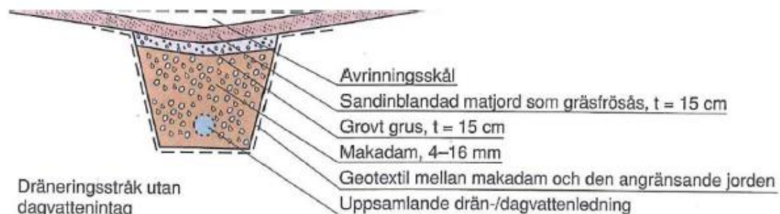
Figur 30. Makadamdike med dräneringsledning i botten. (Svenskt Vatten, 2011).
