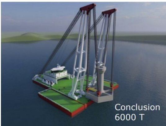
Figur 17. Installation av gravitationsfundament. Övre bild vänster: Utplaning; Övre bild höger: Förberedelse av yta; Nedre bild vänster: Installationspräm; Nedre bild höger: Gravitationsfundament under installation. Källa Per Aarsleff A/S
