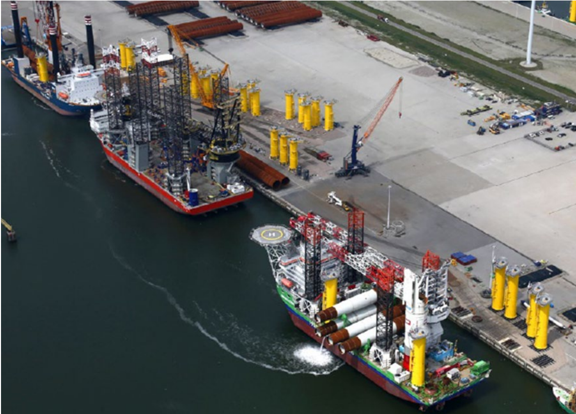
Figur 20. Pråmar med tillhörande stödben (s. kl. jack-up barges). Källa: SiemensGamesa
