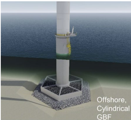
Figur 5. Betongarmering till gravitationsbaserat vindkraftverk (uppe v), transport av vindkraftverk (uppe h). Skiss på gravitationsfundament för havsbaserad vindkraft (nere v), iskon på gravitationsfundament (nere h) källa: Per Aarsleff A/S.
