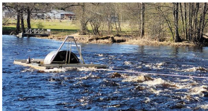
Figur 3. Smolthjulet som användes vid infångandet av laxsmolt vid Forsby i Testeboån. Foto: Sportfiskarna.
