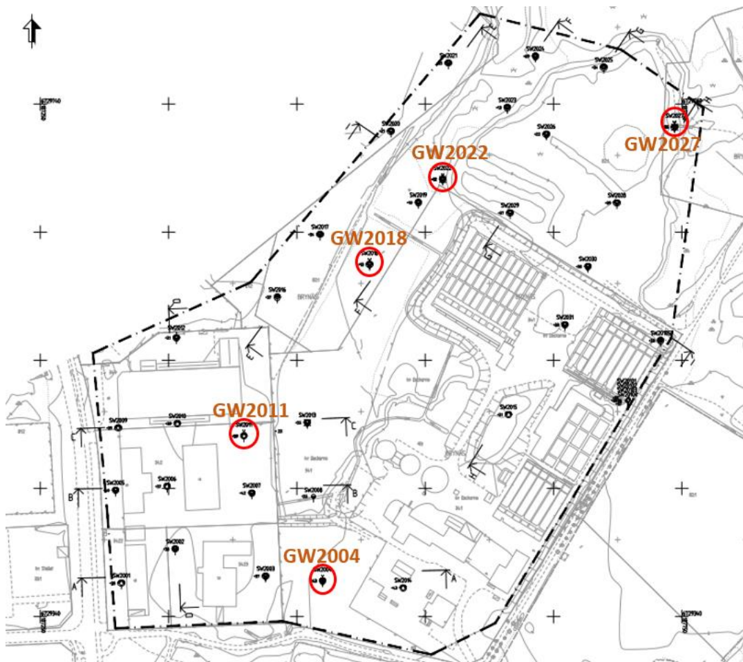
Figur 8. Placering av grundvattenrör. I respektive borrhål GW2022 och GW2027 är två grundvattenrör installerade. (Sweco, 2020)
