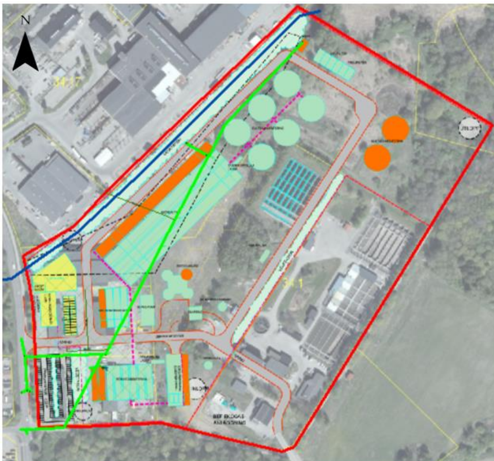
Figur 10. Grön markering visar befintligt läge för dagvattenledningen. Blå markering visar aktuellt förslag på ny sträckning av befintlig dagvattenledning (2020-11-05).
