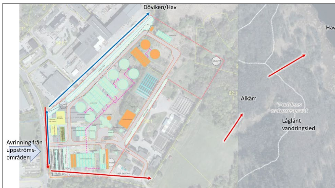
Figur 26. Översiktlig skiss över planområdet samt de två föreslagna avledningarna (blå respektive röda pilar) av ytvavrinning från skyfall. (Figur 14 i Sweco, 2021b).
