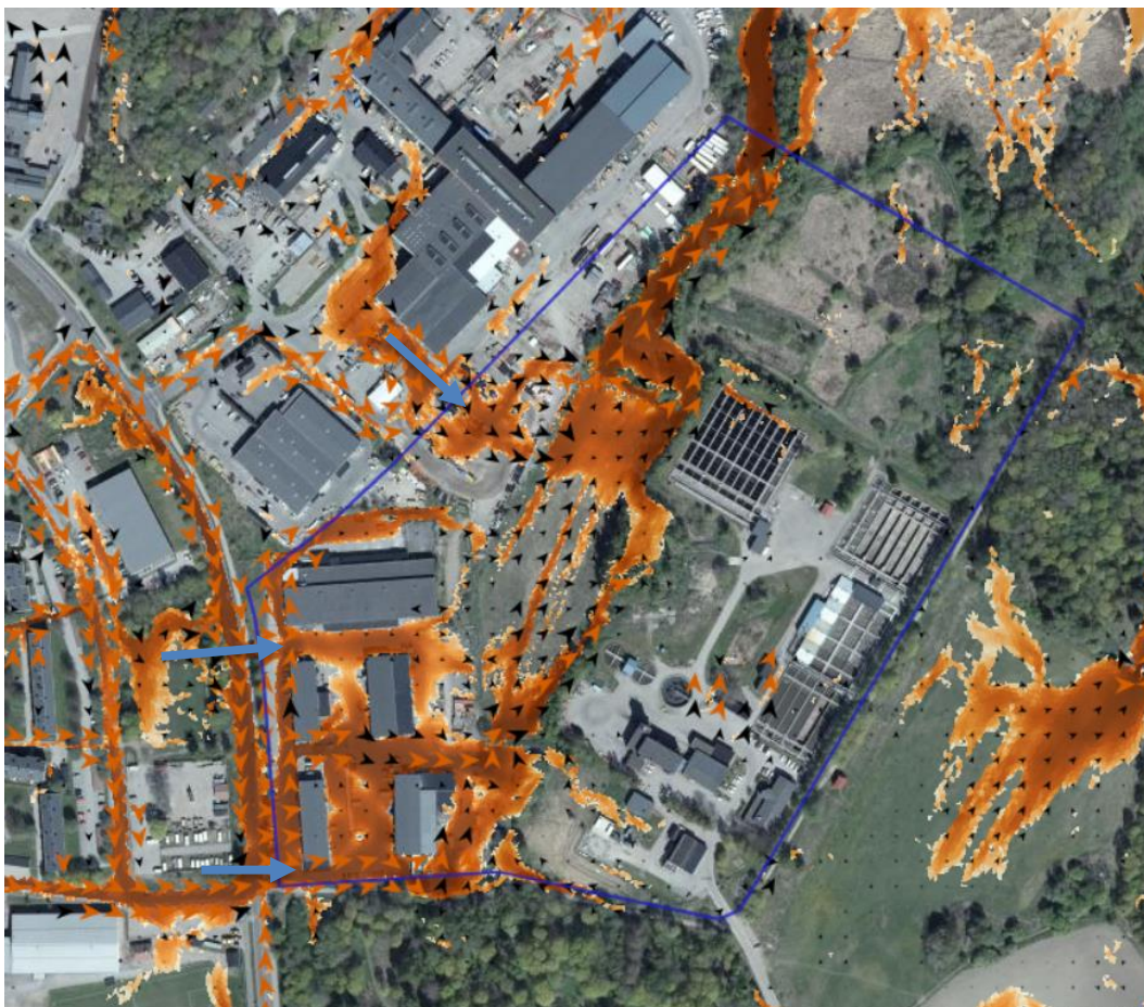
Figur 16. Ögonblicksbild 5 min efter den maximala nederbörden vid ett 100-årsregn. Det orangea skiktet visar ytavrinningen (flux m^3/s/m ) och de svarta och orange pilarna anger flödets hastighet och riktning. Tre större flödesvägar för inkommande ytavrinningen till planområdet identifierades (blå pilar).
