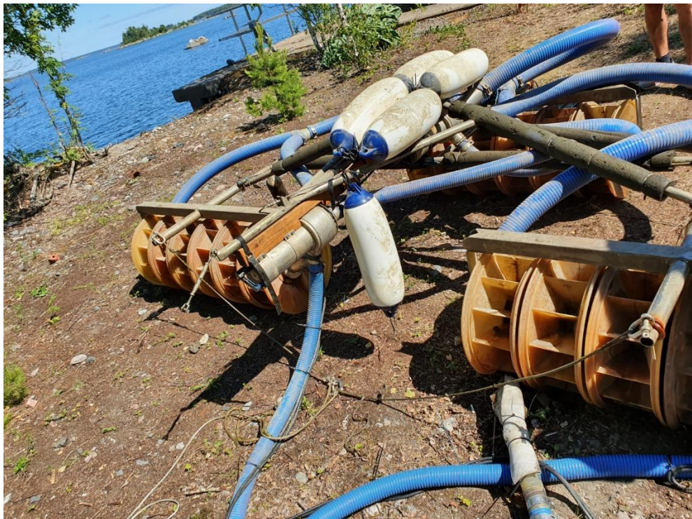
Figur 2. Undervattensenhet för densitetssorterande muddring under en demo i Norrsundet, Gävle kommun.
