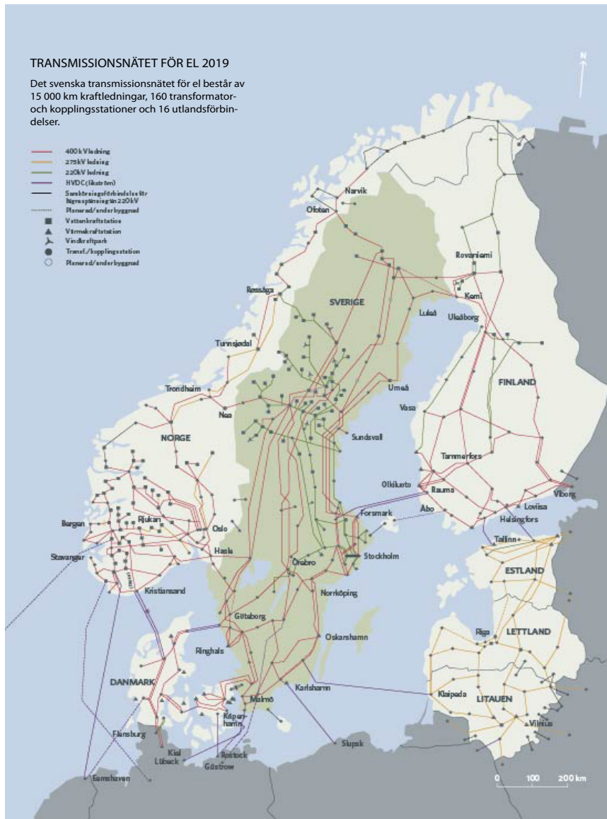
Figur 33. Transmissionsnätet för el 2019 (Källa: Svenska kraftnät, reviderad).
