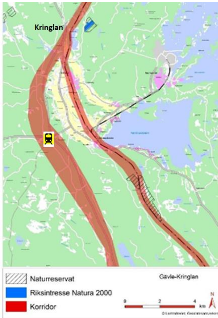
Figur 1 Västlig och östlig utredningskorridor i Hamrångebygd. Möjligt stationsläge i Hagsta är markerat vid den valda västliga korridoren. Källa: Trafikverkets samrådsredogörelse för järnvägsplan Ostkustbanan, dubbelspår Gävle – Kringlan 2017-03-24.
