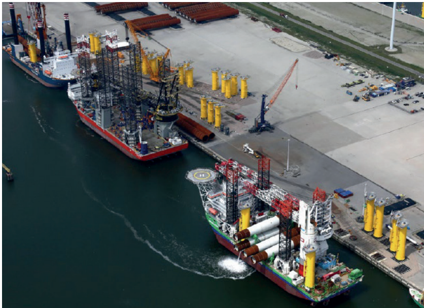
Figur 9. Pråmar med tillhörande stödben (s. kl. jack-up barges)
