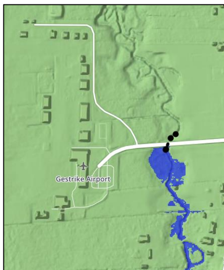
Figur 14. Svart markering visar var trumma under väg antagits för att undvika missvisande uppsamling av vatten i bäcken söder om vägen. Bild visar uppsamling av vatten vid 100 mm regn innan trumma modellerats.
